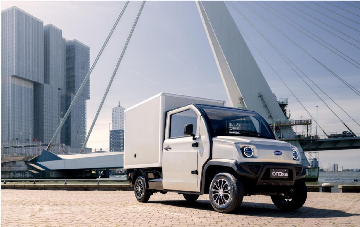
Frisch, modern und leicht - so ist der IONAxS von Spijkstaal. Er ist ein Elektrotransporter mit EU-weiter **Straßenzulassung L7e** und ist bis zu **75 km/h** schnell. Pro Batterieladung kommt er auf eine realistische Reichweite von 200 km\*. Zudem hat eine **Ladebox mit 3m<sup>3</sup>** oder eine Ladepritsche zum Tragen **bis 600 kg** auf der Ladefläche.
