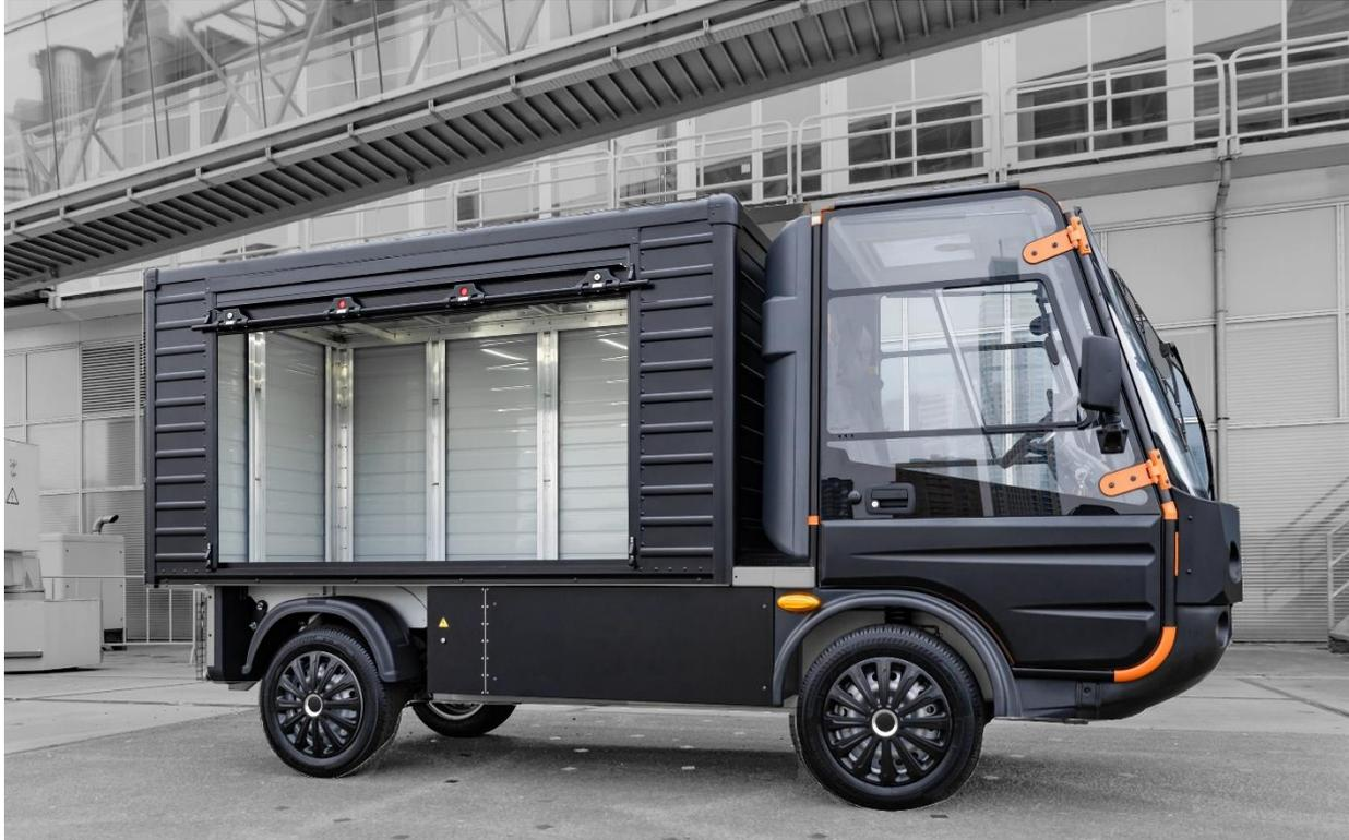
Der neue Elektrotransporter Typ 1200 ist ein reines Elektrofahrzeug und sondert 0% Emissionen im Fahrbetrieb ab. Er hat eine EU-weite **Straßenzulassung (N1)** und ist bis zu **55 km/h** schnell. Unbeladen hat er eine Reichweite bis 180 km\*. Zudem ist er ein Plattformwagen zum Tragen **bis 1200 kg auf der Ladefläche**. Er wird serienmäßig von einem Rahmen aus Aluminium getragen, der zugleich leicht und korrosionsbeständig ist.
